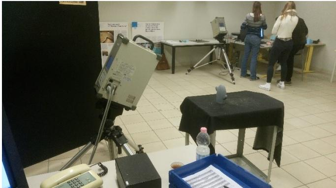
großen Themenbereiche aktive (Laserscanning) und passive (Photogrammetrie) Sensorik, zu denen jeweils eine praktische Übung durchgeführt wurden, bei denen ein Objekt eigener Wahl mittels Laserscan- oder Kameraaufnahme rekonstruiert werden sollte.
