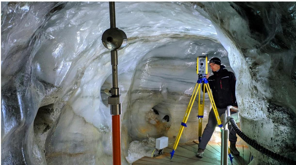
Die Analyse aller Daten ergab dabei, dass aktuell mit einem durchschnittlichen jährlichen Gletscherschwund von 1,8 m bzw. 2,4 m zu rechnen ist. Auch die Eishöhle des Schaufelferners untersteht einer stetigen Fließbewegung. Innerhalb von sechs Jahren sind hier Änderungen im Submeter-Bereich nachweisbar.
